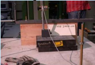
2. GFK Rohr zur Vergrößerung des tragenden Querschnitts
