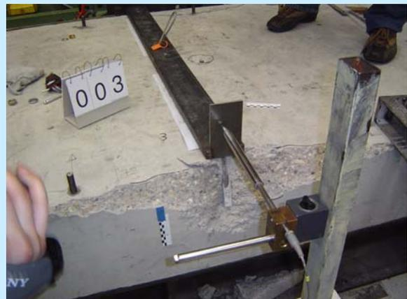
Rückwärtiger Betonausbruch bei Versuchende
