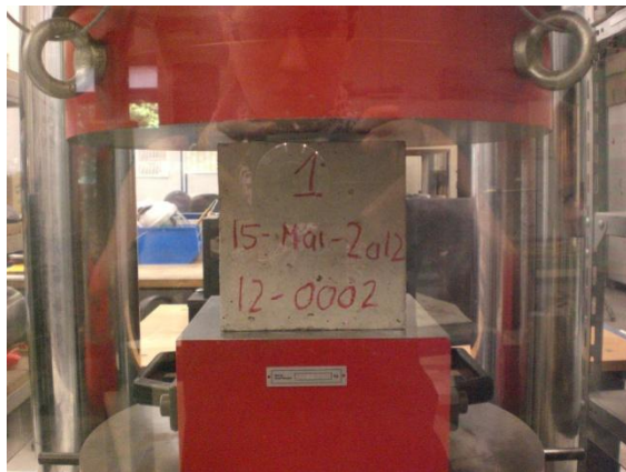
Abb. 13: Betonwürfel in der Prüfmaschine
