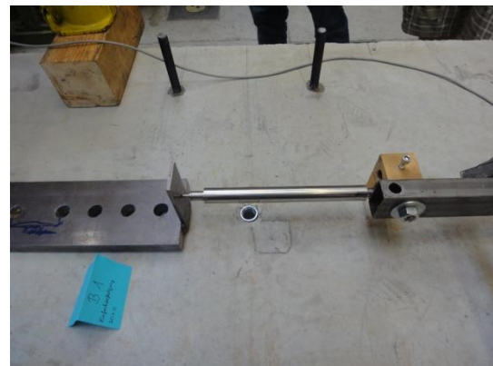
Abb. 48: Wegaufnehmer bei Einfachbefestigungen und hintereinander angeordneten Dübeln
