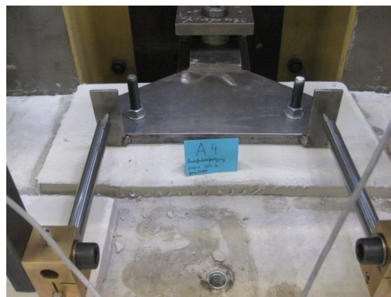
Abb. 49: Wegaufnehmer bei nebeneinander liegenden Dübeln
