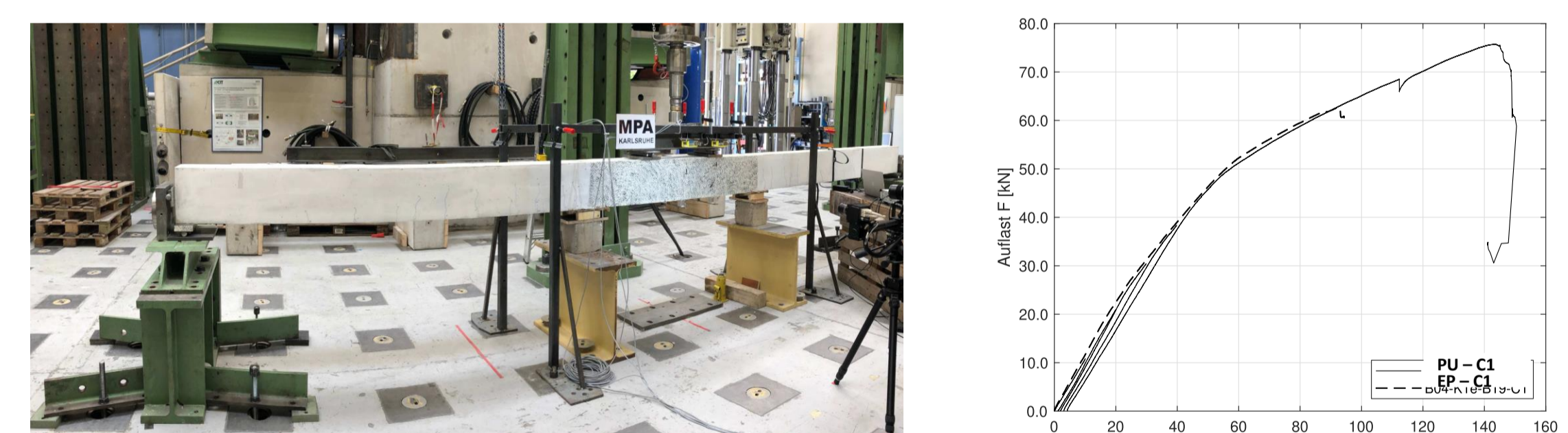
Abb. 4: verstärkter Biegebalken im Vier-Punkt-Biegeversuch (links) und Last-Verformungs-Kurve (rechts)
